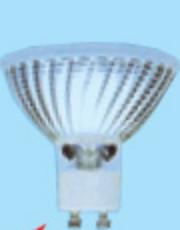
Bon à savoir : un culot GZ10 a des bords à angle droit (voir flèche rouge sur photo). Ce type de culot est uniquement monté sur les lampes munies d'un réflecteur dichroïque. Elles peuvent être placées sur des spots conçus et homologués pour supporter les fortes températures résultant du dégagement de 70 % de la chaleur par l'arrière de la lampe, (effet dichroïque).
