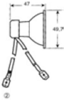
Lampes halogène de signalisation pour fibres optiques.
